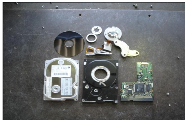
⑥HDD 解体後の素材の回収
